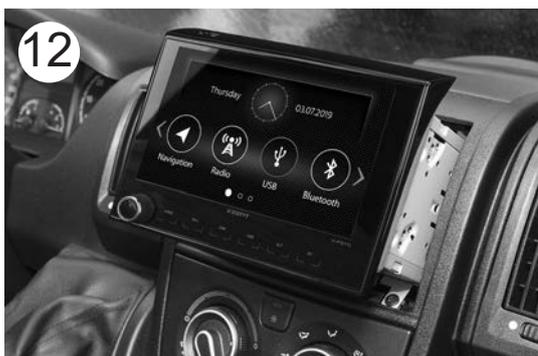
**12** Collegare tutti i cavi precedentemente posizionati nel vano della radio e il cavo originale dell'antenna al sistema XZENT (n. 1). Utilizzare, qualora necessario, l'adattatore ISO-DIN per antenne (n. 13) in dotazione.
