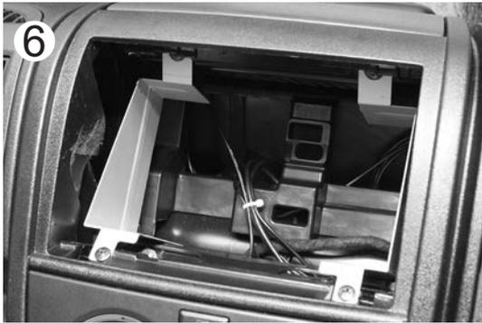
**6** Fissare la struttura per l'assemblaggio nella parte superiore e inferiore utilizzando le quattro viti con intaglio a croce (n. 4) in dotazione al sistema XZENT.
