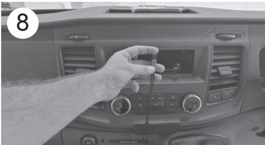
**8** Collegare l'estremità Fakra del cavo dell'antenna (n. 14) alla spina Fakra del cavo dell'antenna sul lato del veicolo.
